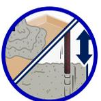
**3** Coloque la mezcla dentro del molde o cimbra y desaloje al aire atrapado, vibrando o varillando.
