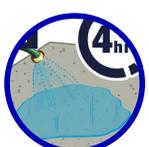
**4** Utilice algún método de curado para mantener hidratado el concreto.
